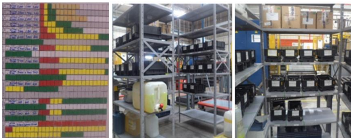
FIGURA 4- Fotos do sistema kanban e dos magazines de supermercado instalado na linha de montagem onde se encontram os principais insumos utilizados na montagem dos conjuntos.
